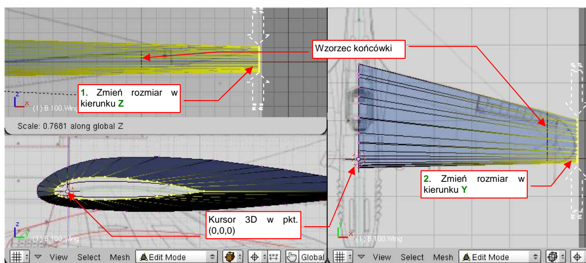
Rysunek 4.4.11 Wytłoczenie ( Extrude ) podstawowego kształtu płata
