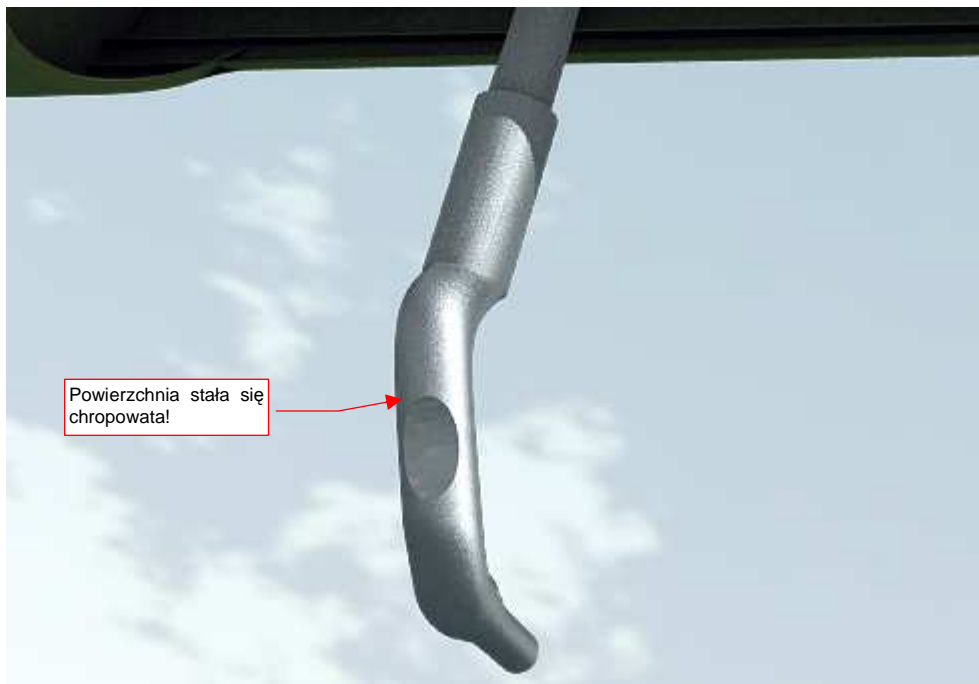
Rysunek 17.15.7 Efekt nałożenia tekstury nierówności ( B.Rough.Metal )
