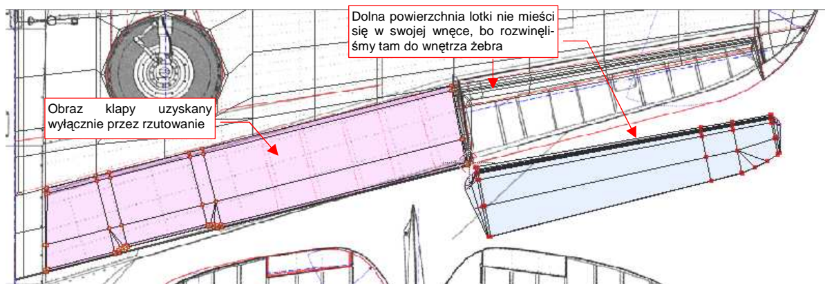
Rysunek 6.6.9 Lotka i kłapa — ułożenie wzdłuż dolnej powierzchni plata.
