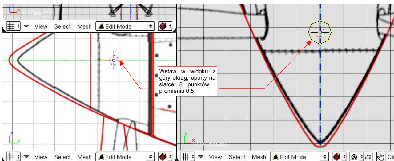
Rysunek 4.3.2 Wstawienie początkowego okręgu
