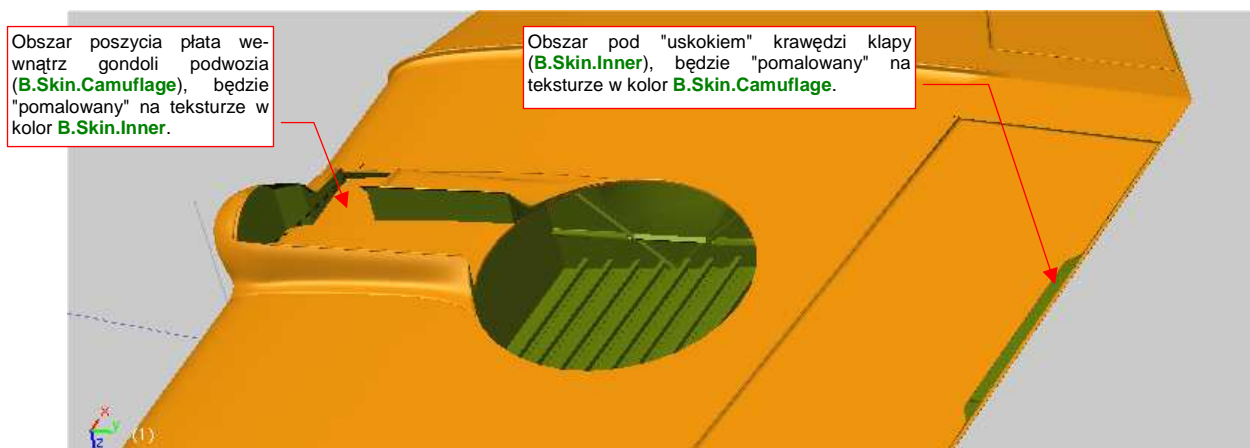
Rysunek 5.2.4 Obszary, w których układ ścian uniemożliwia zastosowanie w siatce dwóch materiałów
