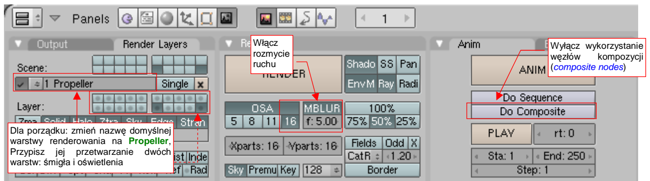
Rysunek 13.12.6 Ustawienia renderowania pomocniczej sceny Propeller
