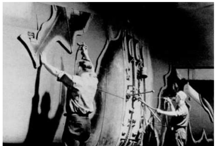
Rysunek 6.12.4 Malowanie płatów P-40 w zakładzie (Curtiss)
