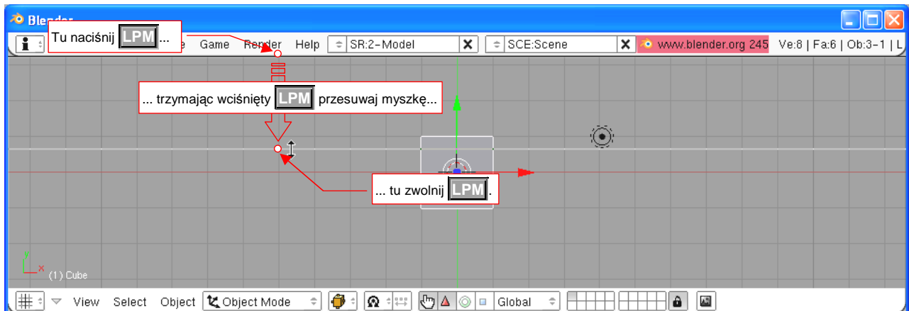
Rysunek 3.1.4 Przesuwanie granicy górnego okna – opcji programu
