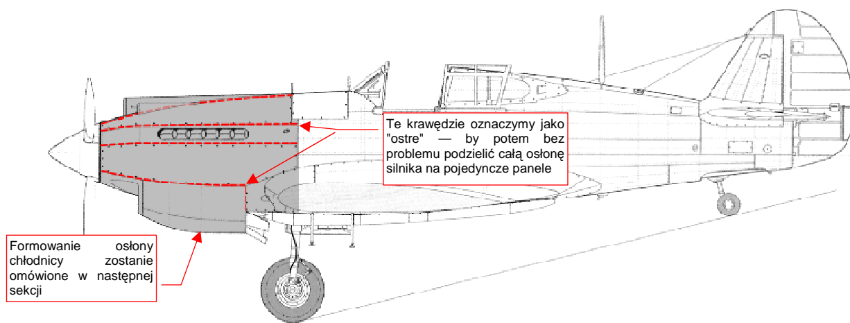
Rysunek 4.11.1 Fragment kadłuba, który odwzorujemy w tej sekcji
