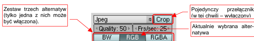
Rysunek 3.5.12 Przykład przełącznika (opcji) Crop i zestawu alternatyw - BW:RGB:RGBA
