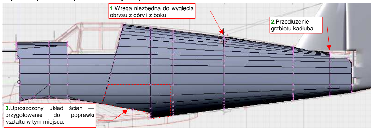
Rysunek 4.10.14 Wstawienie dodatkowych wręg kadłuba
