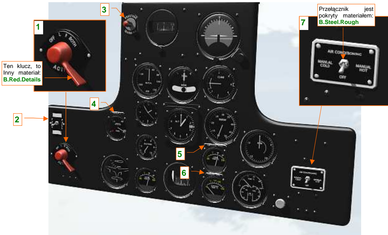
Rysunek 7.5.19 Tablica przyrządów, uzupełniona o pozostałe szczegóły
