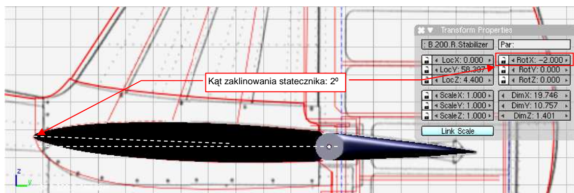
Rysunek 4.8.25 Umieszczenie usterzenia w docelowym miejscu modelu
